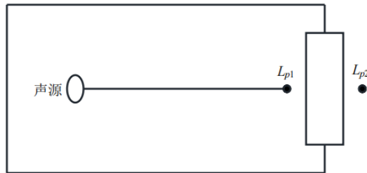
图 4-1 室内声源等效为室外声源图例
